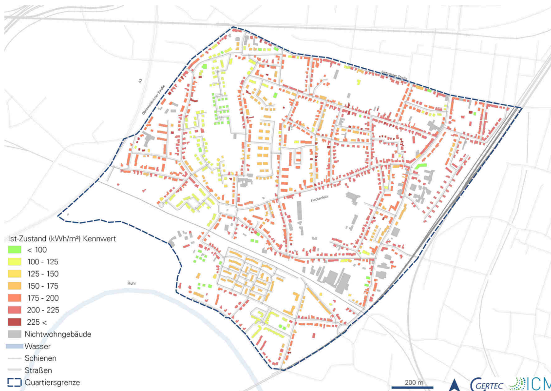
Abbildung 21: Kennwerte der eingesetzten Heizenergie pro m 2
