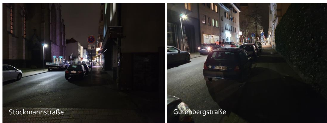
Abbildung 50: Verschatteter Gehweg durch tief angebrachte Beleuchtung und parkende Kfz
