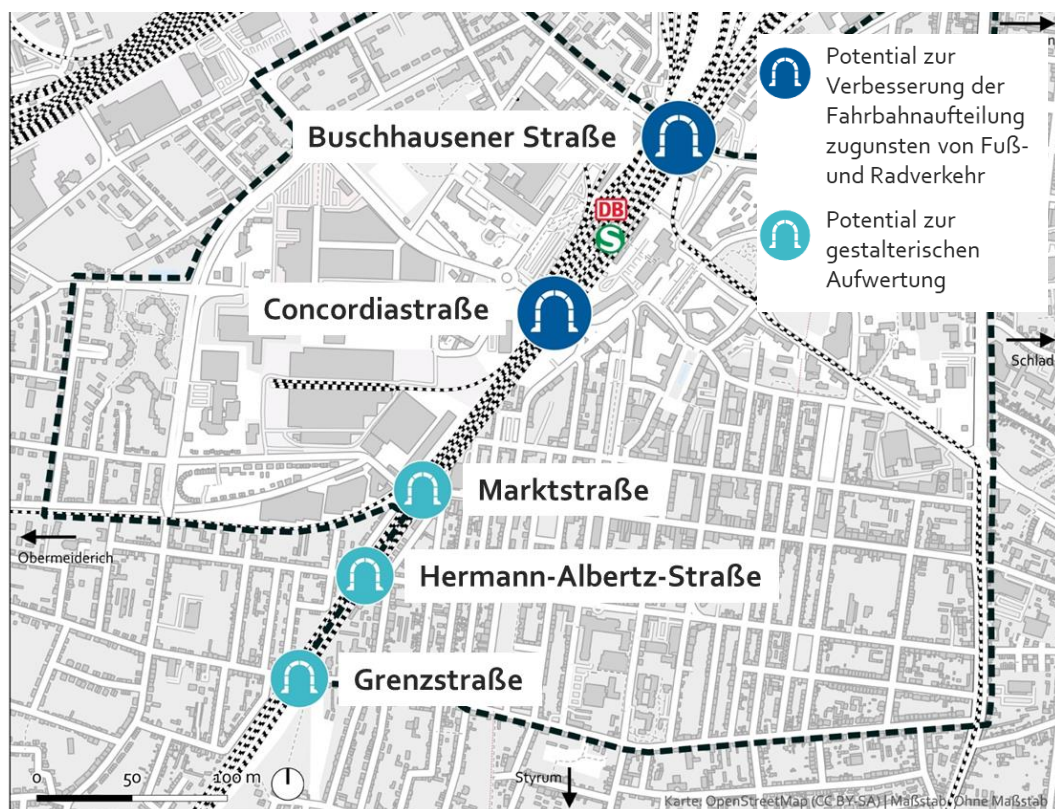
Abbildung 56: Handlungserfordernisse an den Unterführungen
