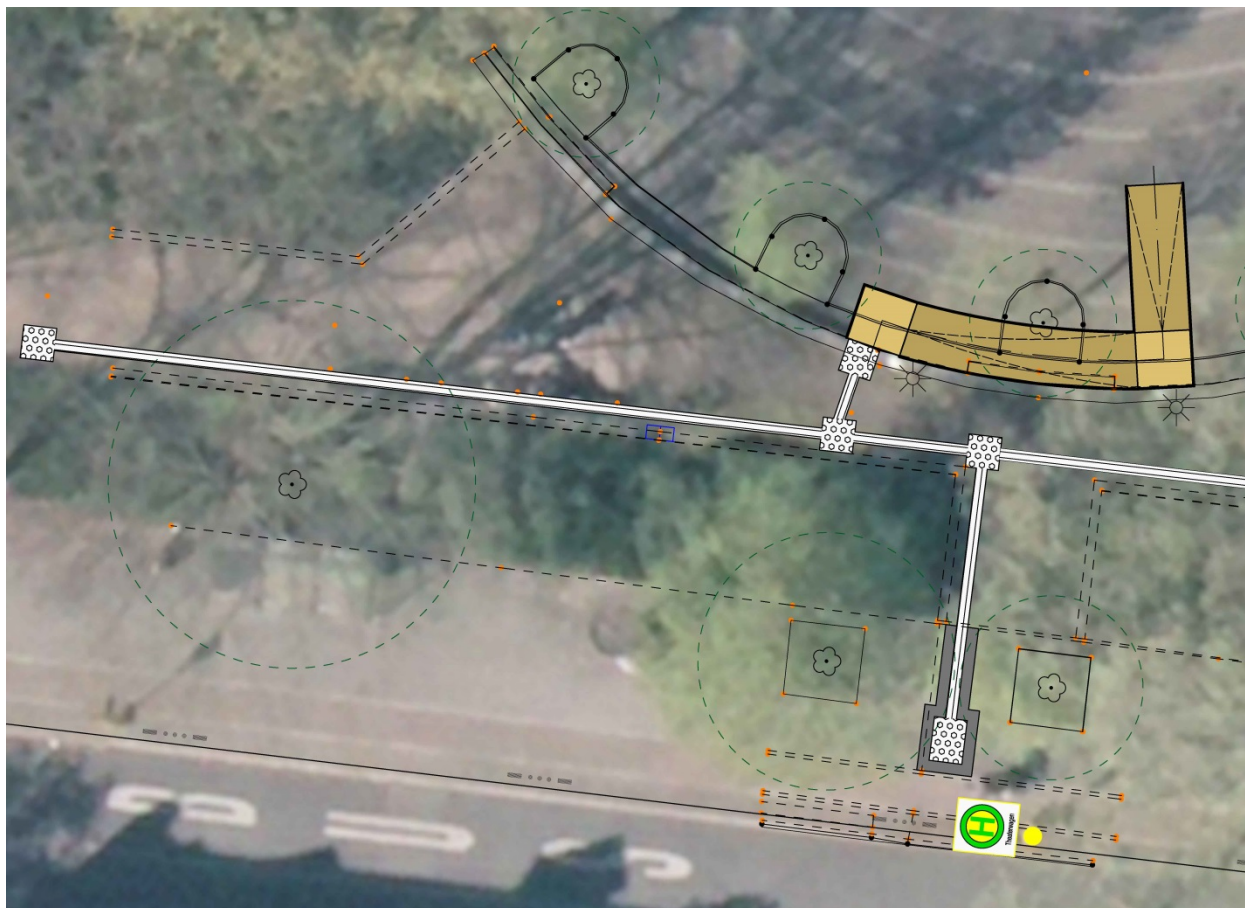
68 69 Abbildung 5: Alternativplanung mit Stahlrampe und taktilem Leitsystem 70
