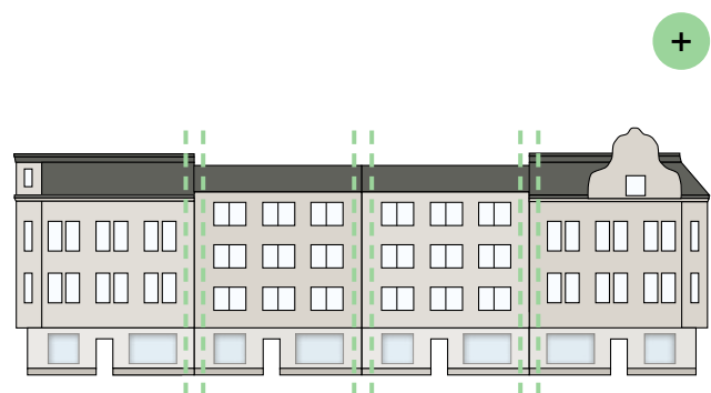
Abb. 82: klare, kleinteilige Parzellierung durch seitliche Wandpfeiler
