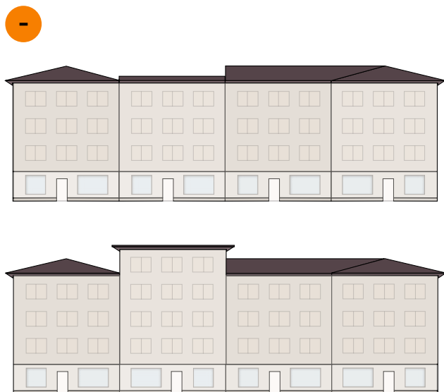
Abb. 99: störende Wechsel der Dachformen
