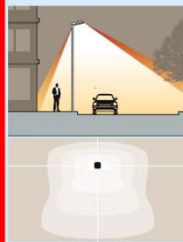
R5 - Lichtverteilung für ein typisches Verhältnis von Straßenbreite zu Lichtpunkthöhe von ~ 2-2,5
