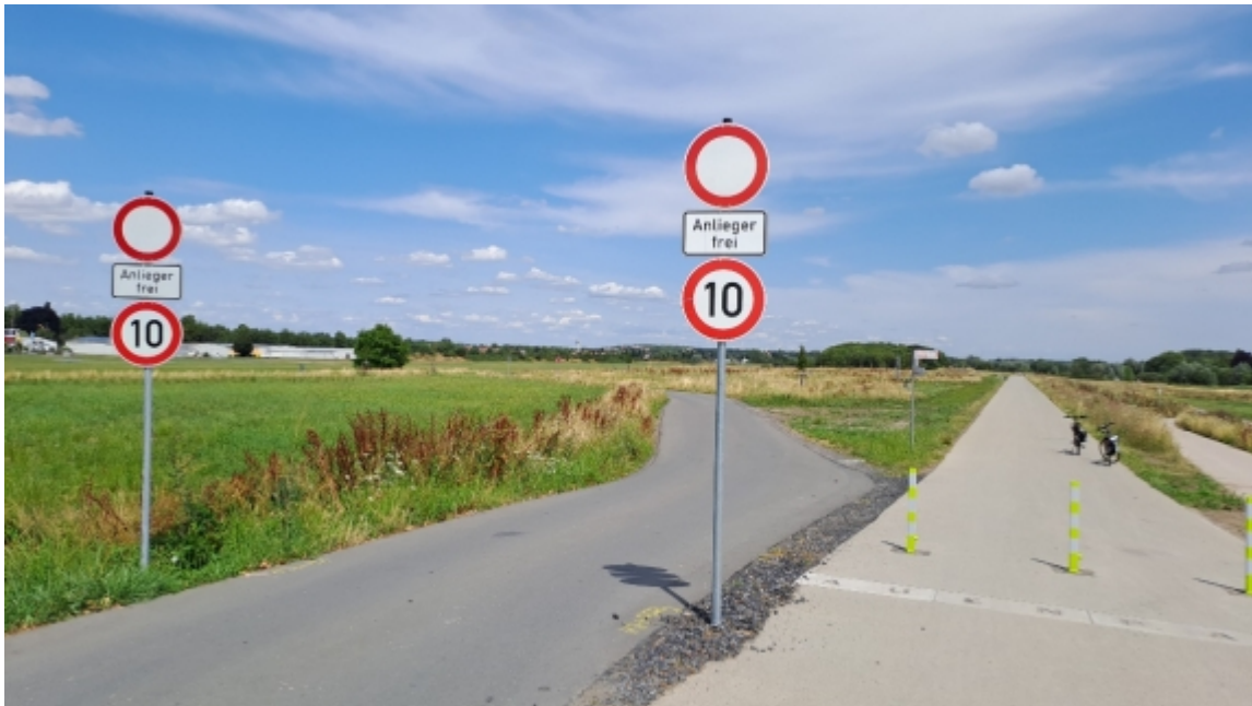
Abbildung 3: Stadt Hamm (2022) - Farbasphalt im Erlebnisraum Lippeaue (rechts) im Vergleich zu heller Gesteinskörnung (links)
