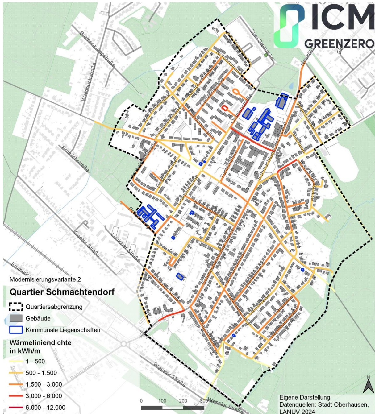
Abbildung 69: Darstellung der Wärmelinien-dichte nach Umsetzung der Modernisierungsvariante 2
