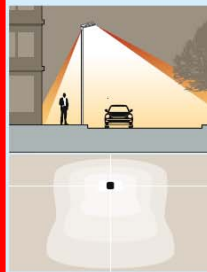
R5 - Lichtverteilung für ein typisches Verhältnis von Straßenbreite zu Lichtpunkthöhe von ~ 2-2,5
